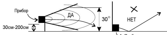
Ультразвуковые волны, испускаемые прибором способны распространяться на расстояние 4~6 метров в пределах одного помещения и должны быть направлены к твёрдым поверхностям (металл, бетон и т. д.) так, чтобы они могли несколько раз пере отразиться в различных точках помещения и, интерферируя, заполнить всё пространство до насыщения.
