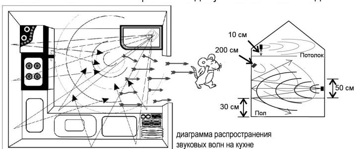
Физические свойства ультразвука не позволяют ему проникать сквозь стены, перекрытия, двери и т. п. или огибать препятствия. Поэтому ультразвуковой прибор может защитить только то помещение, в котором он установлен. Для достижения оптимального эффекта необходимо устанавливать прибор в каждом помещении, где имеется проблема с грызунами.
